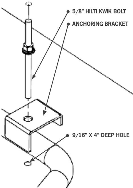
PROPER ANCHORING ORDER FIGURE H
