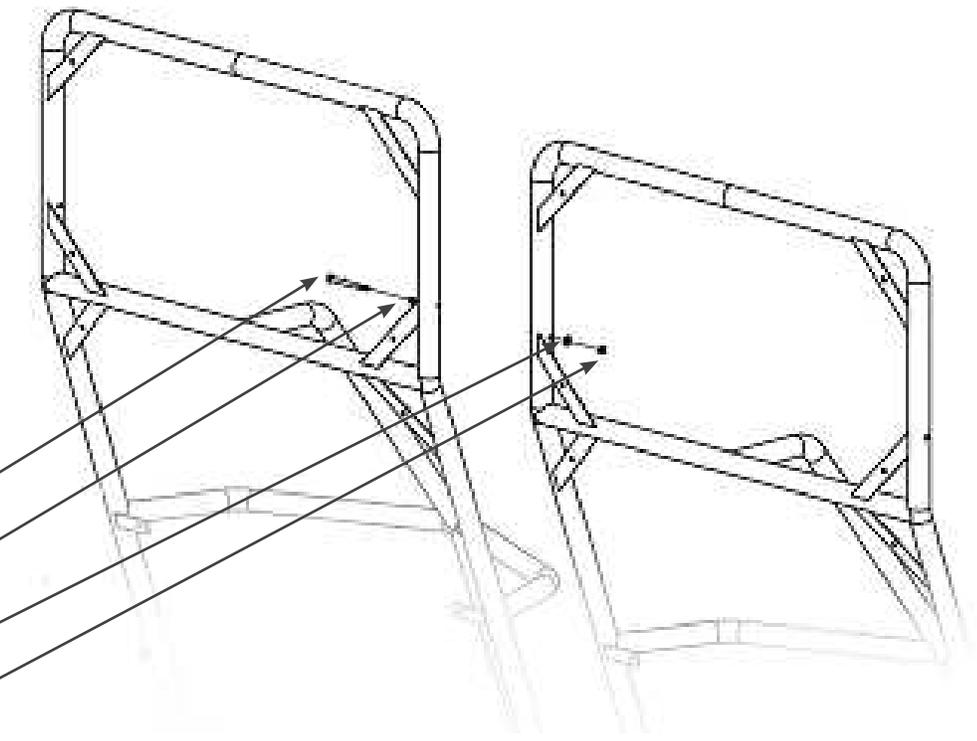
FASTEN FRAMES TOGETHER FIGURE F
